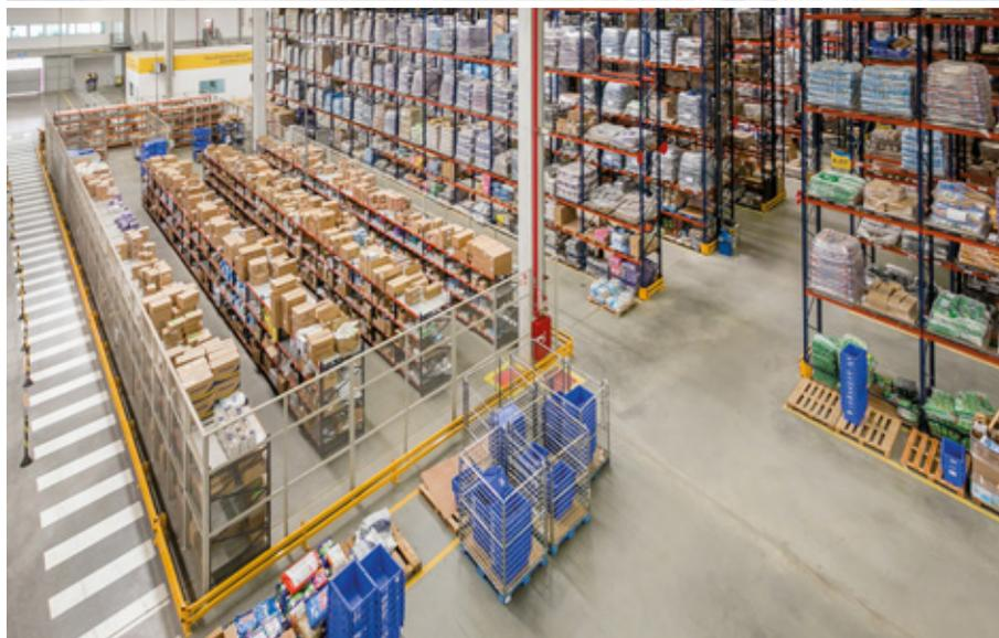
A área foi isolada através de painéis de tela com portas de acesso e proteções laterais colocadas em todo o seu perímetro
