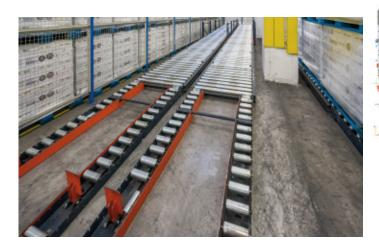
O sistema de pré-cargas reagrupa os paletes de um mesmo pedido ou rota e agiliza a operação de carga nos caminhões de distribuição
