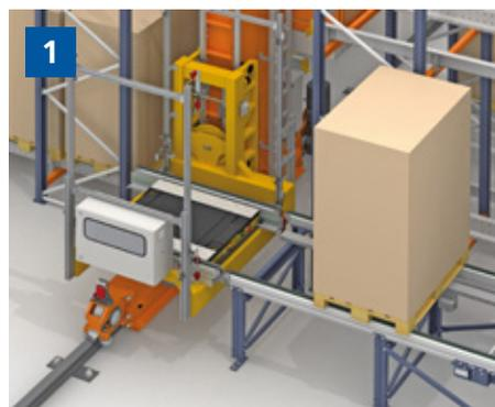
1. O Pallet Shuttle no berço do transelevador espera a chegada do palete proveniente do posto de inspeção.
