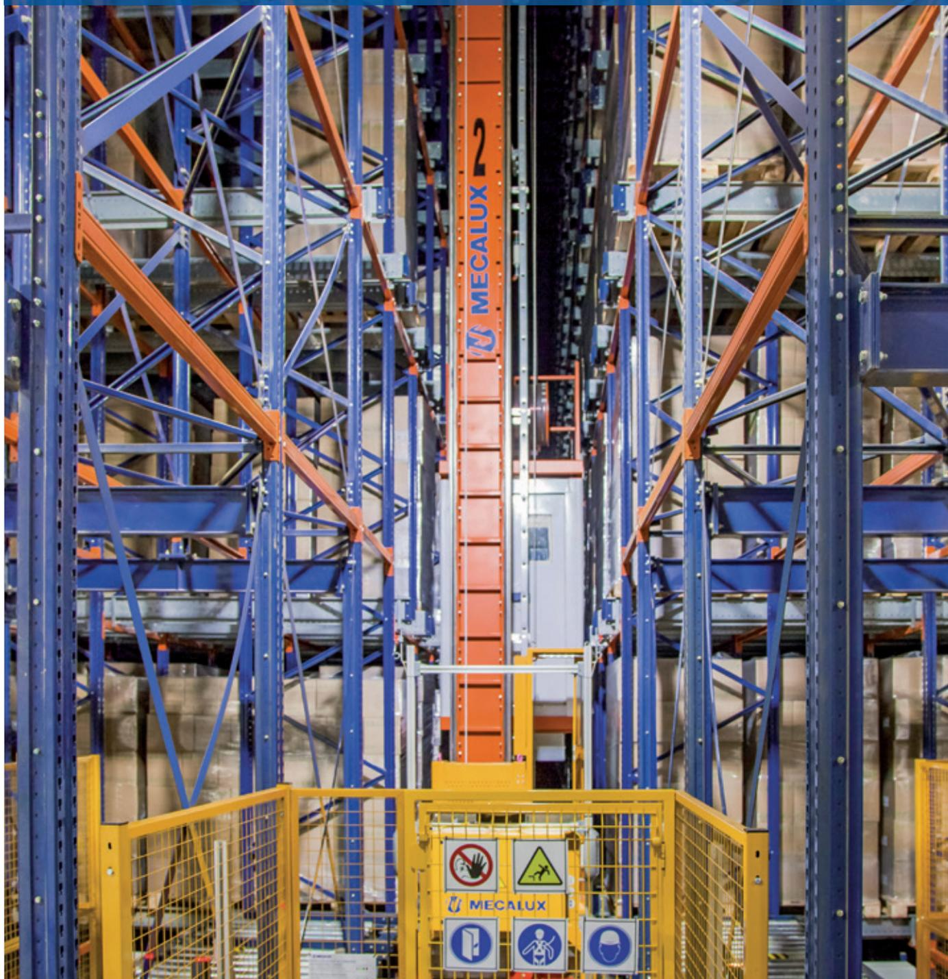
A Bem Brasil, fabricante de batata pré-frita congelada, construiu um armazém automático autoportante de 25 m de altura com capacidade para mais de 33.000 paletes. Este armazém inteligente foi equipado com o sistema Pallet Shuttle, que utiliza transelevadores. Também foi implementado o sistema Easy WMS da Mecalux, o software de gestão que tem a função de dirigir com eficiência as operações e processos efetuados.
