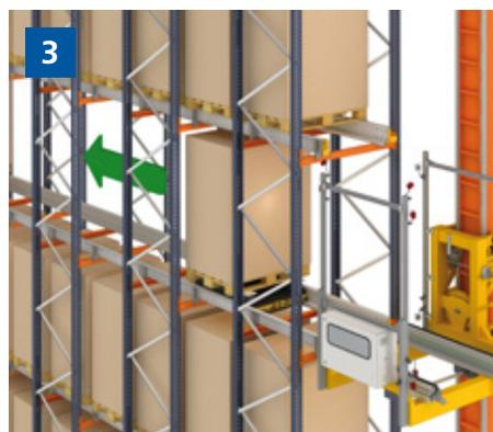
3. O carro automático levanta a carga com delicadeza colocando-a no canal de armazenamento. O carro desloca-se com o palete para a primeira localização livre e, uma vez ali, desce o palete para apoiá-lo na parte superior do trilho.
