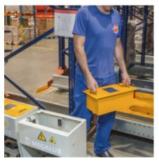
O operador emite as ordens de movimento ao Pallet Shuttle através de um tablet conectado por Wi-Fi. Este dispõe de uma tela táctil e um software intuitivo, que não requer formação especifica para operação. Cada tablet pode interagir com todos os carros do armazém seguindo um protocolo de prioridades. O sistema de carregamento das baterias é de fácil acesso para os operadores. Baterias extras ficam carregadas e disponíveis, permitindo sempre a operação dos carros.
