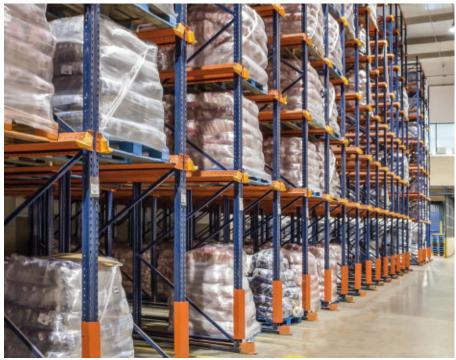
Os operadores, auxiliados por máquinas retráteis, entram nos corredores com a carga elevada acima do nível em que serão depositadas. No solo há trilhos-guia que permitem que as empilhadeiras sejam colocadas centralizadas e circulem pelo interior dos corredores com total segurança, minimizando a possibilidade de causar danos acidentais às estantes.
