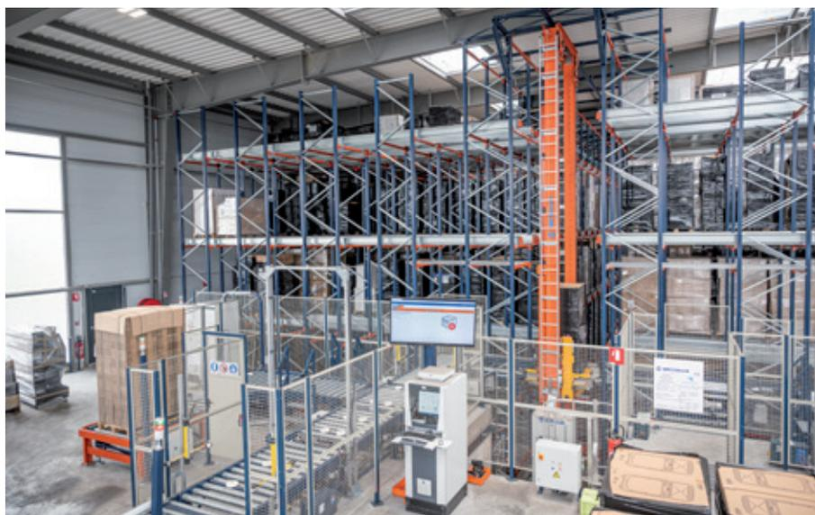
sa e eficiente. “Ele colocou o armazém em um poço de 2 metros de profundidade para atingir a capacidade de armazenamento de que precisávamos, respeitando as normas de altura do prédio”, afirma Michel Verlhac, presidente da Verlhac Logistique.
