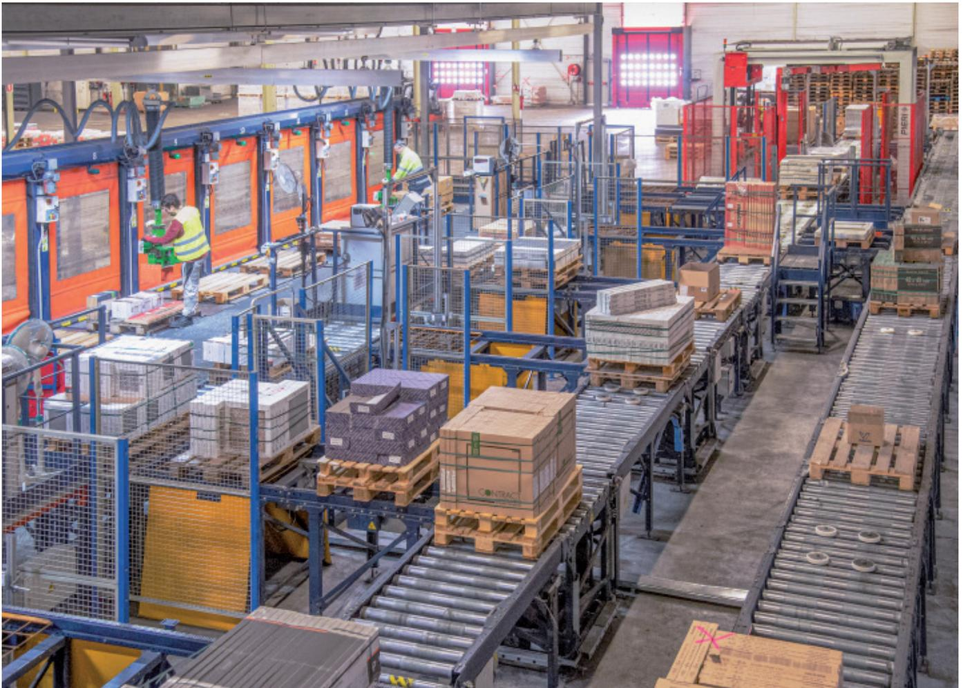
lumosos. Diante deste desafio, a Mecalux montou uma área de preparação de pedidos composta por transportadores, lançadeiras e estações de picking com equipamentos de manuseio que facilitam o trabalho dos operadores.
