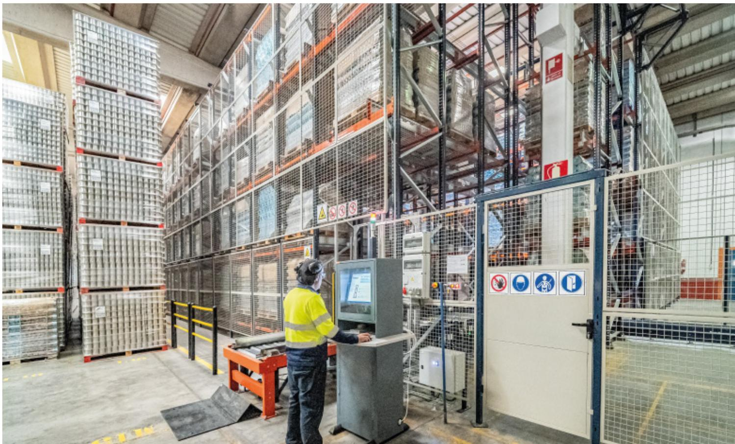
por um transelevador, um sistema de armazenamento por compactação que aumentou a eficiência do armazém do Grupo Envases. Além de otimizar a superfície para ampliar a capacidade de armazenamento, a empresa se beneficiou da robotização para agilizar e manter um controle mais preciso da entrada e saída de mercadorias.
